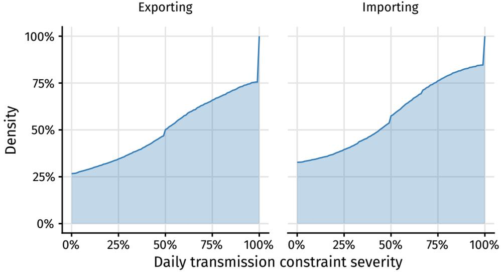
FIGURE 2: CUMULATIVE DISTRIBUTION OF TRANSMISSION CONSTRAINT SEVERITY
